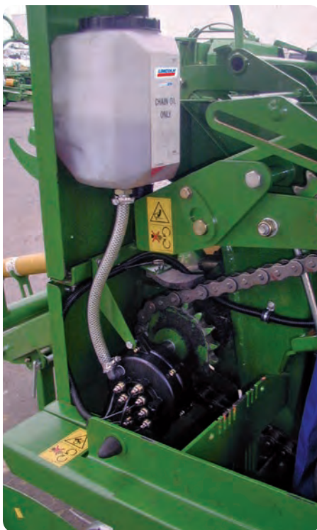
Machine agricole (presse à balles) avec système de lubrification MOS / MOP 212
